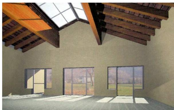
Il progetto prevede la realizzazione di una struttura con quattro aule didattiche, sala d'ingresso con copertura in legno lamellare, sala da pranzo ed altri servizi tutti collocati su un piano terra di 810 mq di superficie; è previsto inoltre un piano interrato di circa 90 mq. È prevista anche la realizzazione di un
